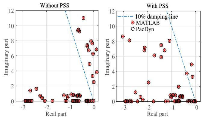
Fig. 15 – 68-bus system: Plots of eigenvalues
