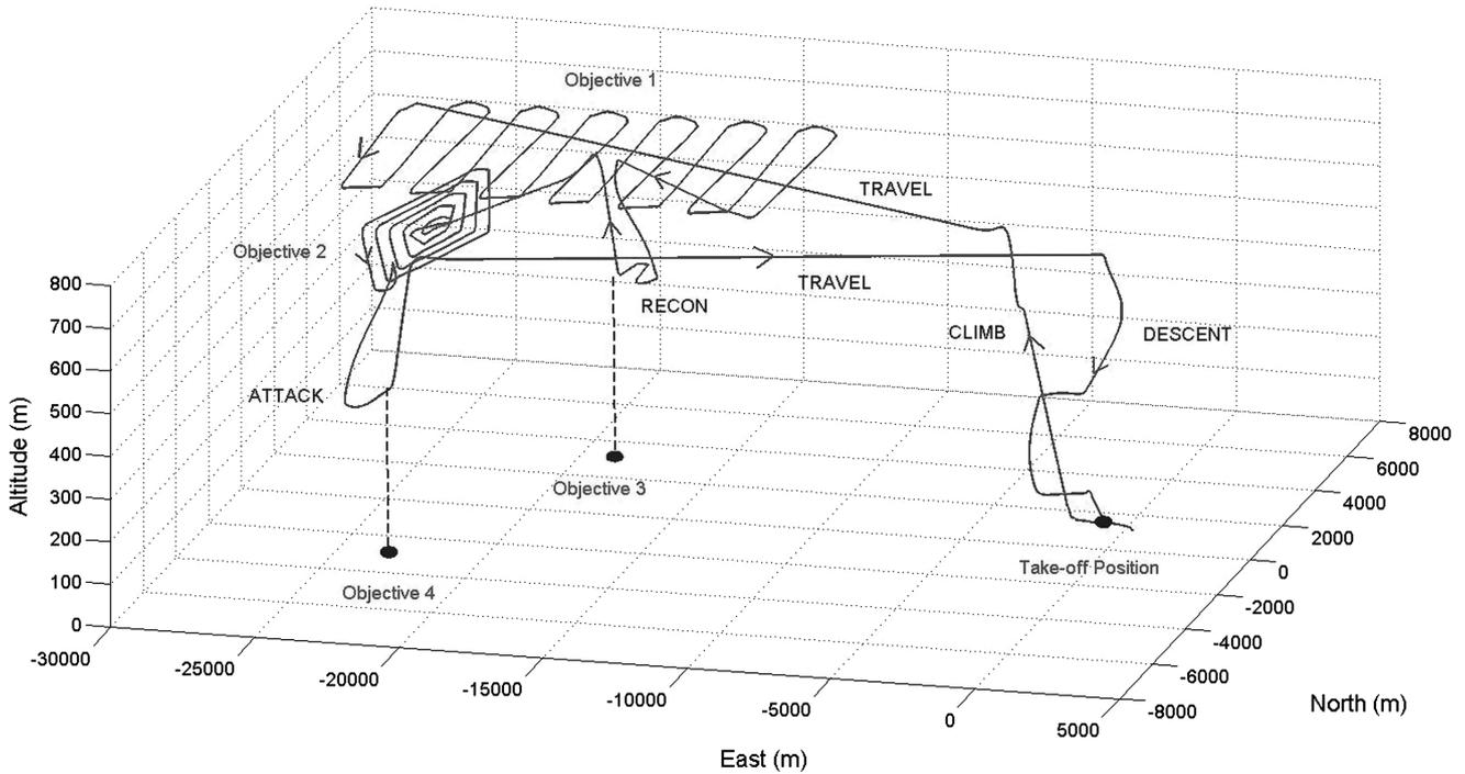
Fig. 5 Scenario 2e trajectory plot.
